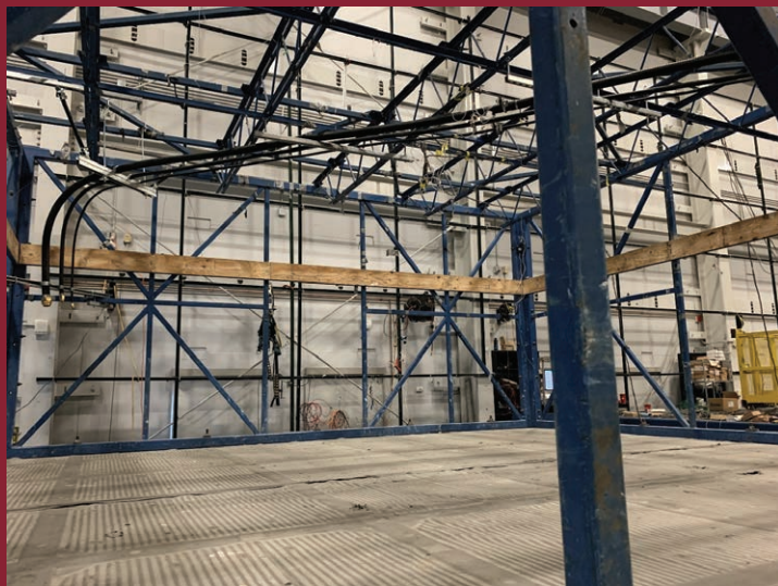
CounterStrike® CSST in seismic test rig.
